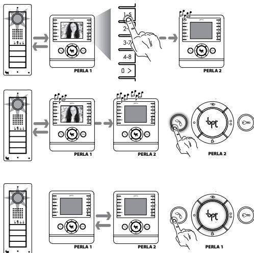
Если связь активна, выберите номер устройства для переадресации вызова; нажмите клавишу на принимающем абонентском устройстве.
