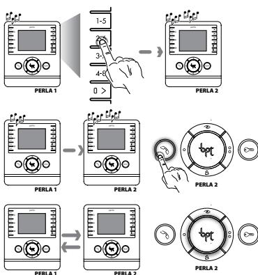
При вызове одним абонентским устройством другого, мелодия звонка отличается от вызова с вызывной панели и может быть изменена. Чтобы принять вызов нажмите клавишу **📞** на абонентском устройстве
