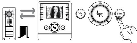
Отображение открытия замка двери на вызывной панели
