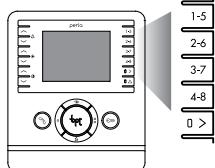
Нажмите на соответствующие клавиши для вызова других абонентских устройств от 1 до 4; нажмите на клавишу **>** (светодиод включен), чтобы выбрать устройства с номером от 5 до 8.
