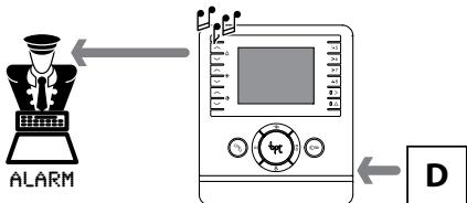
Если к специальному входу абонентского устройства подключено дополнительное сигнальное устройство, его активация вызовет передачу сигнала тревоги на пульт консьержа и продублирует этот сигнал на абонентском устройстве (прерывистый звуковой сигнал в течение 10 секунд).
