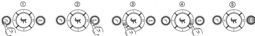
Активация аудиосвязи ①, Открытие замка двери выбранной вызывной панели ②, и активация вспомогательных устройств ③ ④. Светодиод горит постоянно, если дверь открыта в системах, предназначенных для передачи данного сигнала ⑤.
