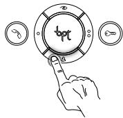
Для отключения сигнала звонка нажмите клавишу **A**. Все типы вызовов будут приходить к пользователю без звука (только видео); светодиод будет гореть пока активирован данный режим. Чтобы снова включить сигнал вызова повторно нажмите клавишу **A**.
