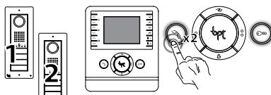
Для завершения просмотра дважды нажмите клавишу или дождитесь автоматического окончания просмотра (максимум 60 секунд).
