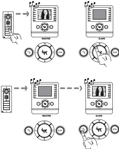
В случае, когда вызов приходит на несколько абонентских устройств одновременно, звонок будет проходить на все устройства. Но видео активируется только на устройствах, настроенных как "MASTER". Для передачи видео на "SLAVE" устройство нажмите на нем клавишу **👁**. Для включения аудиосвязи нажмите **📞**.
